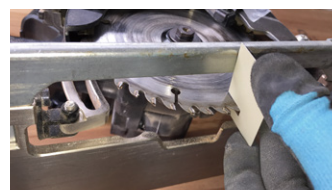
丸のこゲージ使用して適確な刃の出幅に簡単調節
