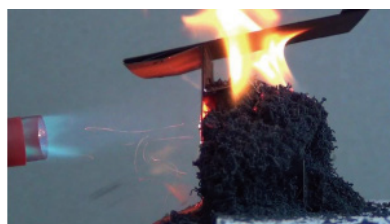
●熱膨張材が膨張、開口を閉塞
