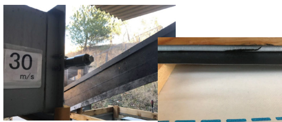
試験後壁通気層内の写真 (漏水なし)
